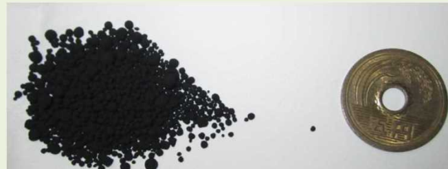
湖西浄化センター燃料化物の形状
