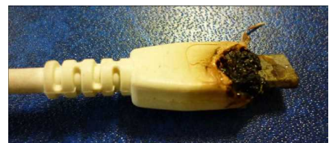
内部が変形したコネクタを使い続けたために温度が上昇し、発煙（上） 焦げたコネクタ（下）
