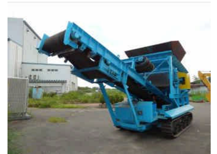
写真 1.2-3 振動篩 (斜め前)
