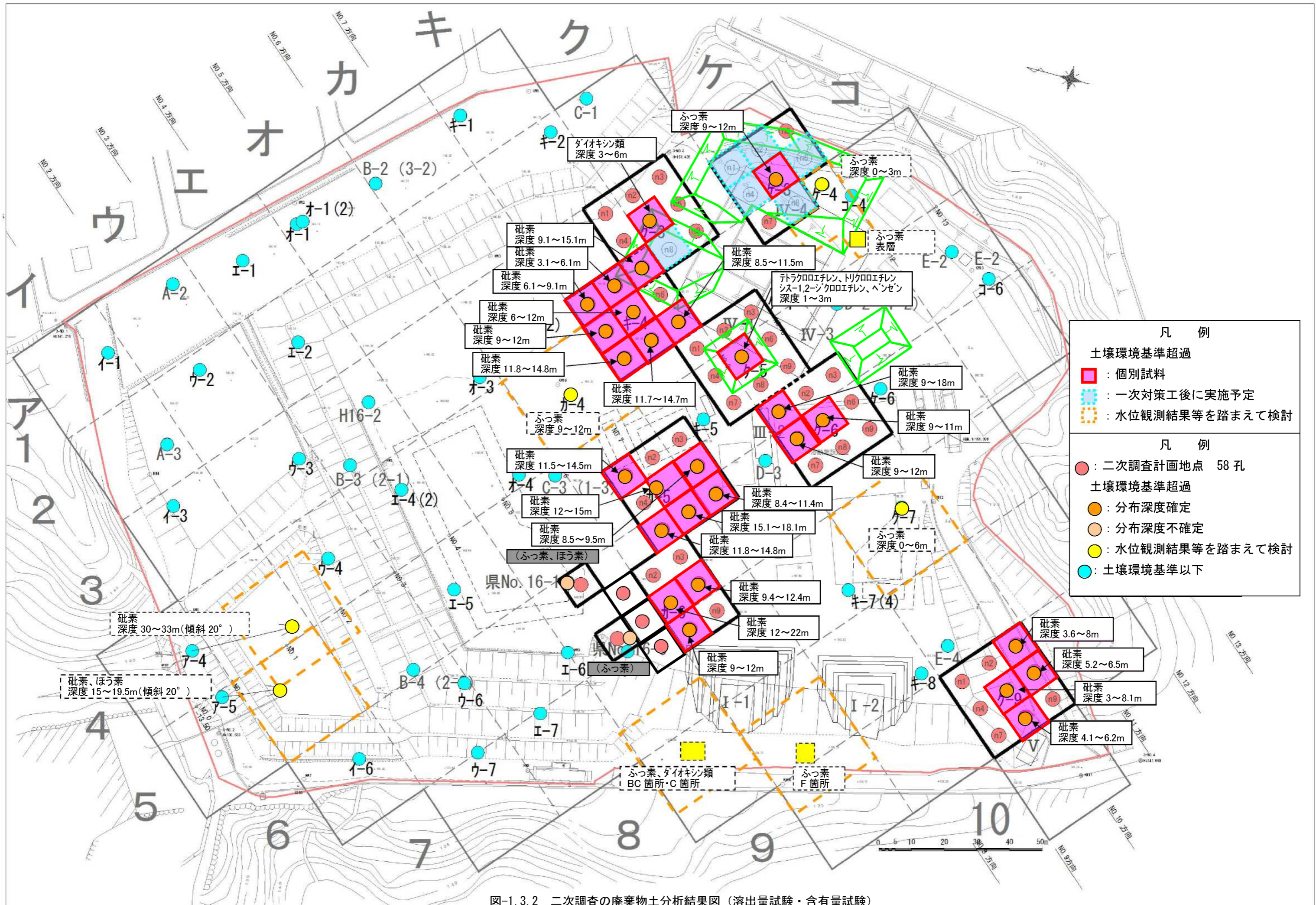
図-1.3.2 二次調査の廃棄物土分析結果図（溶出量試験・含有量試験）
