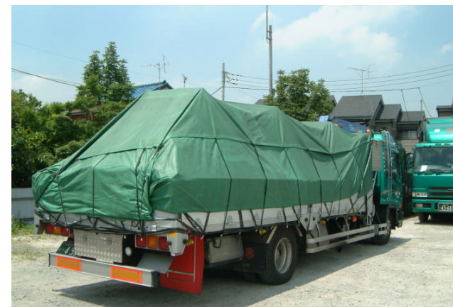
写真-4.4.4 廃棄物運搬車両（シートで覆った事例）
