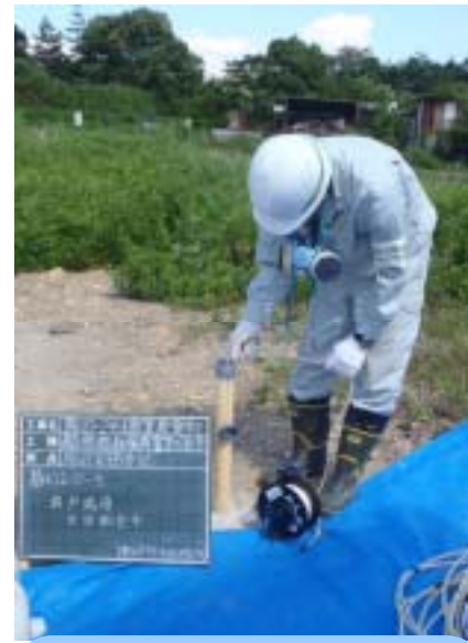
写真-1 孔内水位の測定状況
