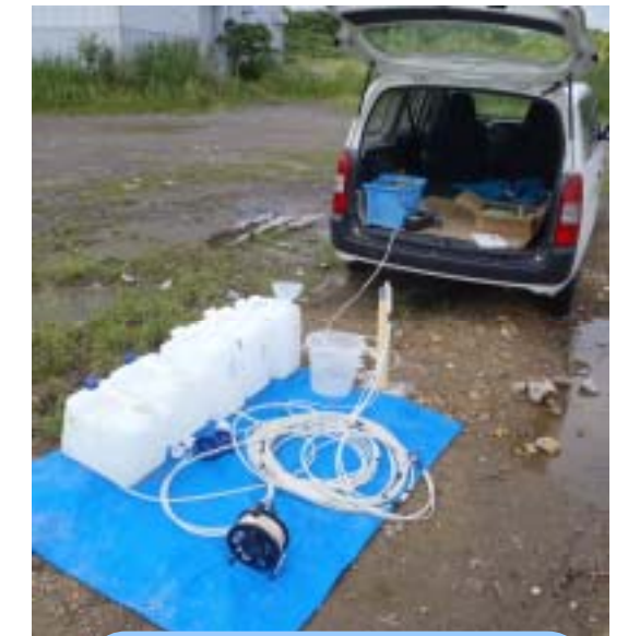
写真-3 パージ作業状況
