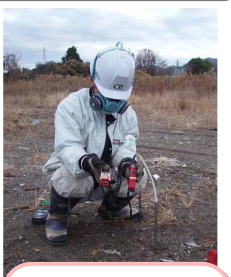
写真-6 携帯型ガス測定器(理研計器製GX-2001等)
