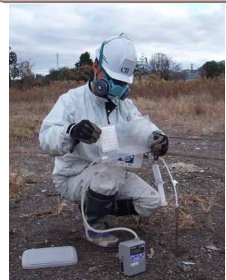
写真-4 表層ガス採取状況
