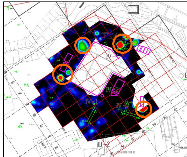
図-4.4.3 EM調査結果抜粋（焼却炉付近）
