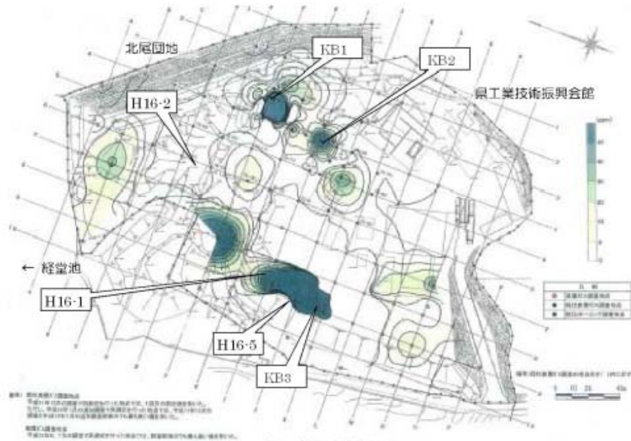
図-19 表層ガス中の硫化水素濃度の等濃度線図 (平成11年11月~平成12年7月測定)
