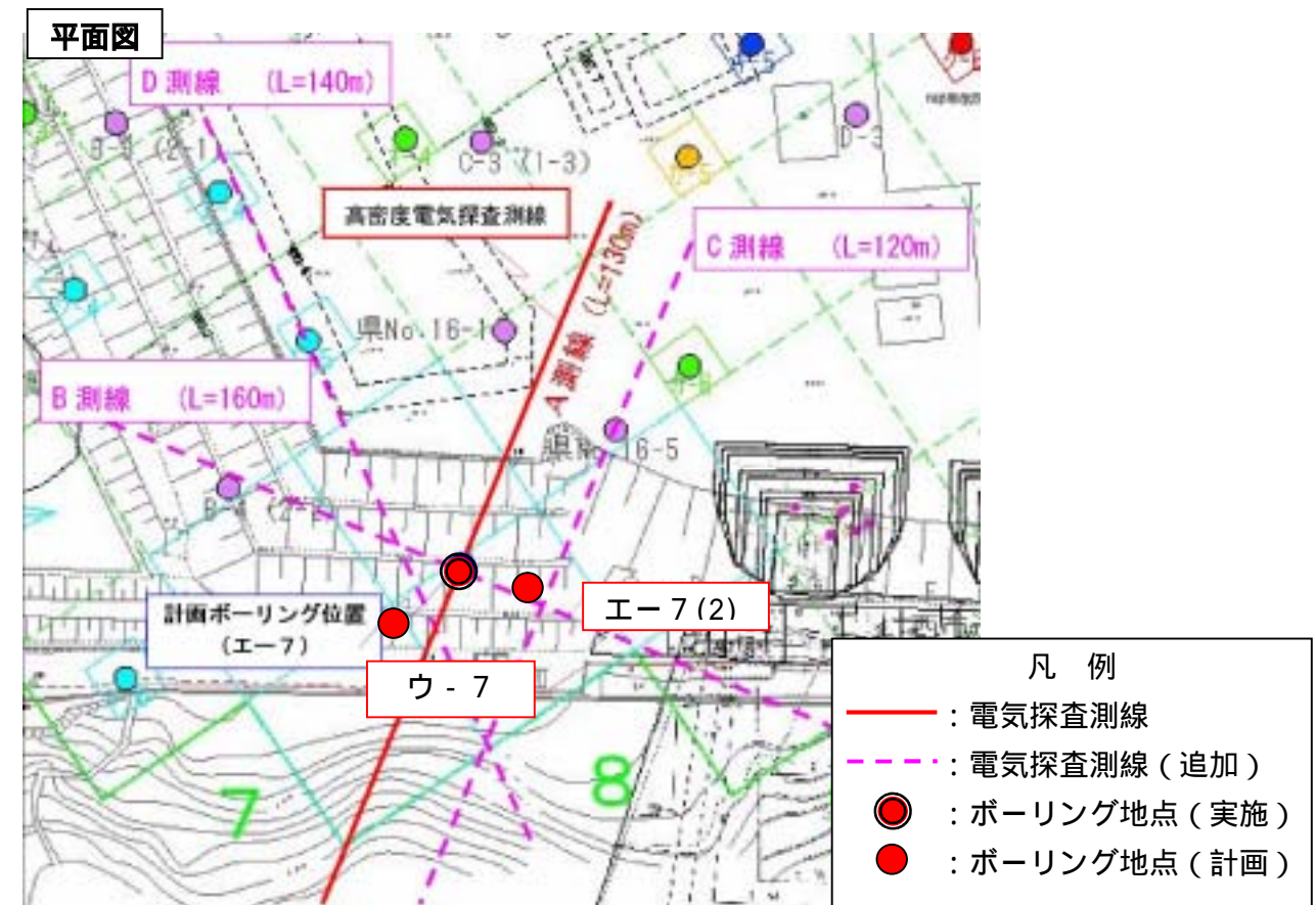
図-3.2.4 ドラム缶調査 ボーリング計画位置図（案）
