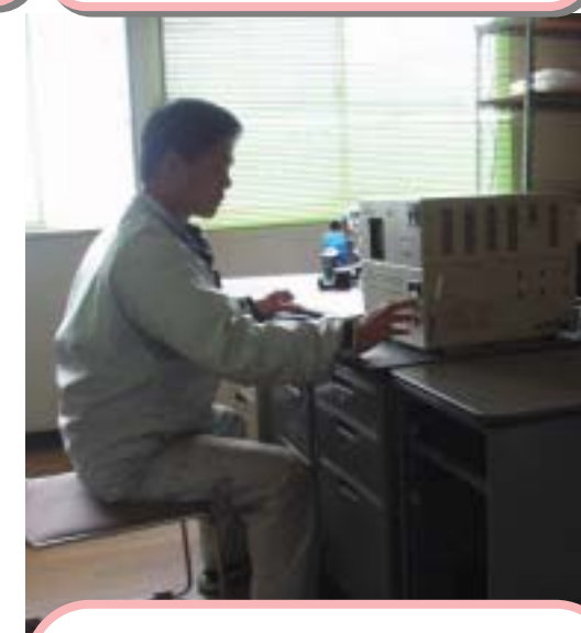
写真-5 ポータブルガスクロマトグラフでのVOC測定
