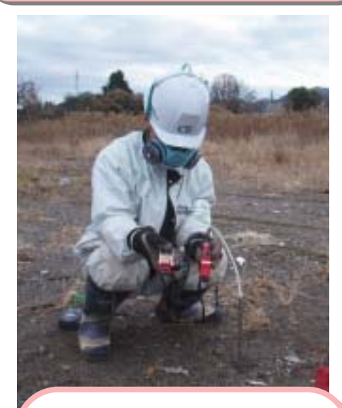
写真-6 携帯型ガス測定器(理研計器製GX-2001等)でのガス測定
