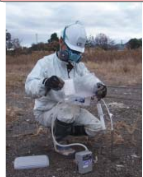
写真-4 表層ガス採取状況
