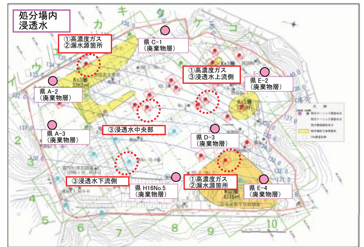
図-4.4.4 処分場内浸透水の 신설観測井戸配置図 (案)
