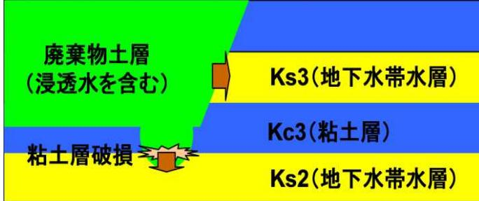
【Ks3層地下水】側面で廃棄物土層と接していることにより、廃棄物土層の浸透水が地下水に移流拡散していると考えられます。
