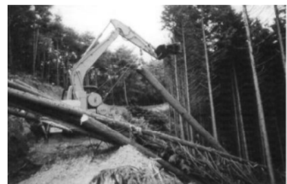
近年は高性能林業機械(スイングヤーダー等)により搬出。
