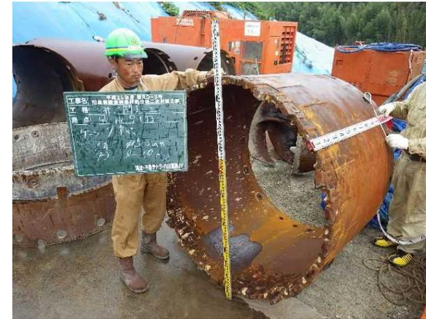
オールケーシング工法 鋼管先端 金属刃
