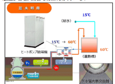
(老朽管更生工事と同時に熱交換器を設置するシステムの模式図)
