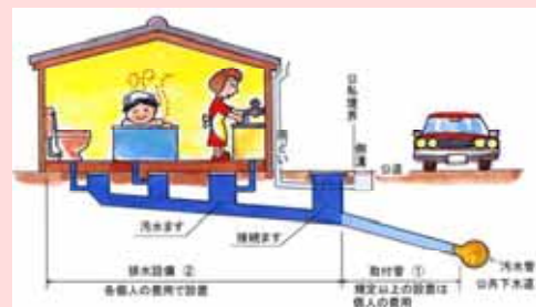
(下水管本管と宅内排水設備)
