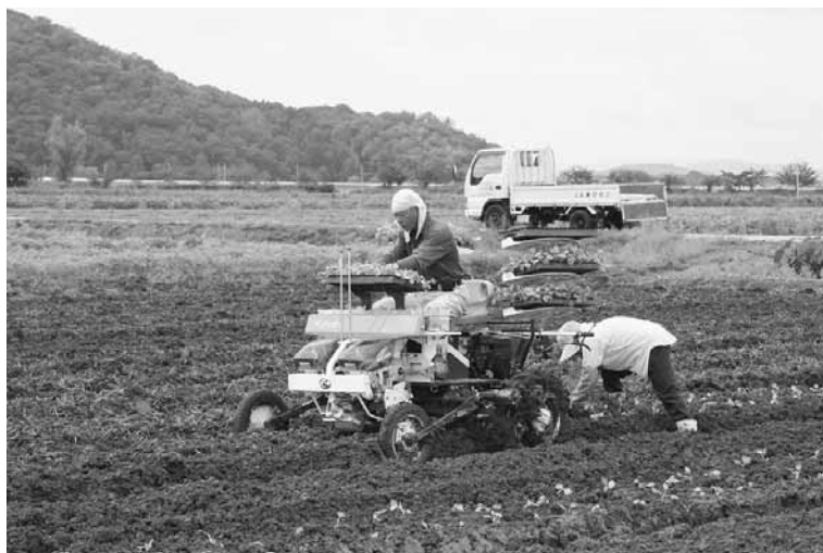
定植機によるキャベツ苗の植え付け作業
