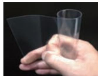
写真1. フレキシブル透明導電性フィルム「スタクリア®」
