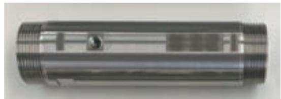
↑ 通常ポンプから出る水流では、池の水が白濁することはありませんが、発生器 (写真右下) を使用することにより効率的にファインバブルを発生させ、池の酸素濃度を向上させています。
