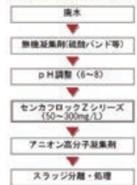
硫酸バンド添加後 pH調整し、センカフロックZシリーズ、次いでアニオン高分子凝集剤を加えてスラッジを分離・処理する。
