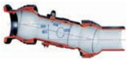
「フレキベンダー」の構造。両端のボール部に二重管構造の中間部を組み合わせた構造とすることで、管路に生じる屈曲、伸縮、捻れなどの複合変位を吸収
