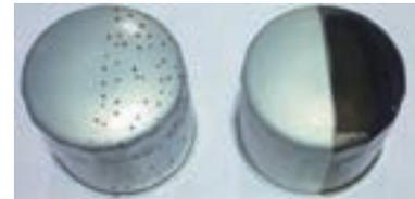
洗浄サンプル（墨汁ぬれ性試験）。左が洗浄前、付着油のために墨汁がはじかれている。右が洗浄後で、油分が除去され均一にぬれている。
