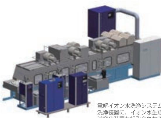
電解イオン水洗浄システムの全体像。コンベア式洗浄装置に、イオン水生成装置、油水分離装置、減容化装置を組み合わせている。
