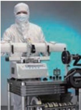
IR溶着の様子。継手、パイプ端面を電遠赤外線加熱して溶着接合を行う。強固かつ接合部の応力が少ないため、残留応力によるクラックの発生を抑えることが可能である。
