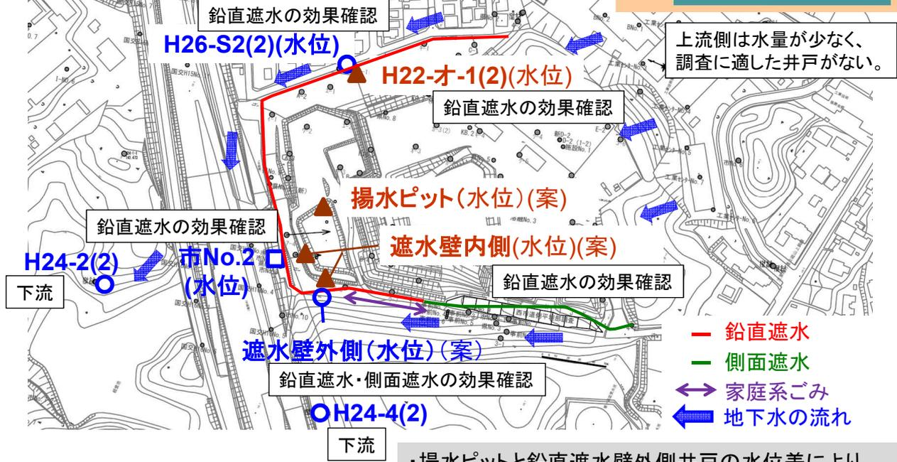
・揚水ピットと鉛直遮水壁外側井戸の水位差により、鉛直遮水の効果を確認できない場合は、遮水壁内側に井戸を設置する。
