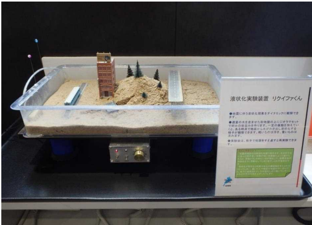
体験型実験装置（液状化実験装置 リクイファくん）
