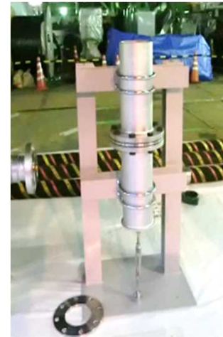
大容量ポンプ海水系統～冷却水系統 接続ディスタンスピース入替訓練設備
