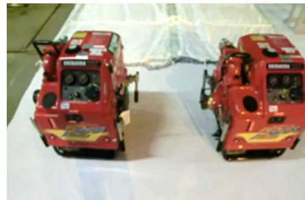
消防ポンプ起動手順訓練設備
