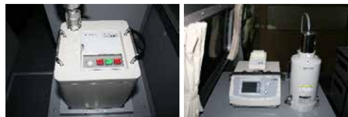
資機材例 【4台】 (可搬型ダストヨウ素サンプラー)
