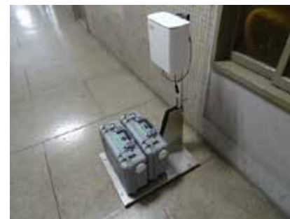
可搬型モニタリングポスト 【12台】
