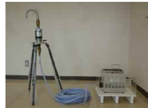
資機材例【10台】 (可搬型ダストヨウ素サンプラー)
