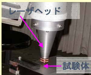
気中切断試験
