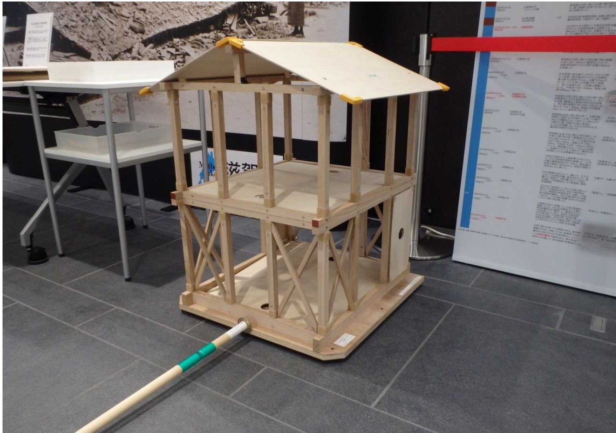
体験型実験装置（木造2階建住宅倒壊模型 ピノキオぶるる）
