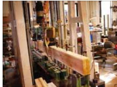
曲げ強度・曲げヤング係数の測定
