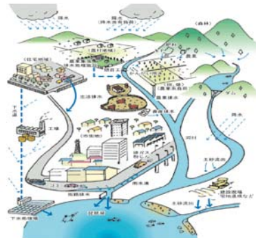
点源、面源負荷の発生から琵琶湖に流入する概念図
