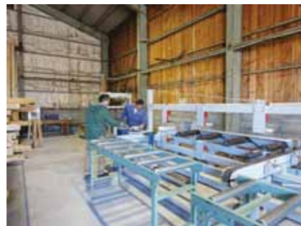
機械等級区分を行うグレーディングマシン。適用対象となる製材の寸法は、断面寸法の短辺が90mm以上150mm以下、長辺が90mm以上390mm以下、長さが3m以上6m以下となっています。
