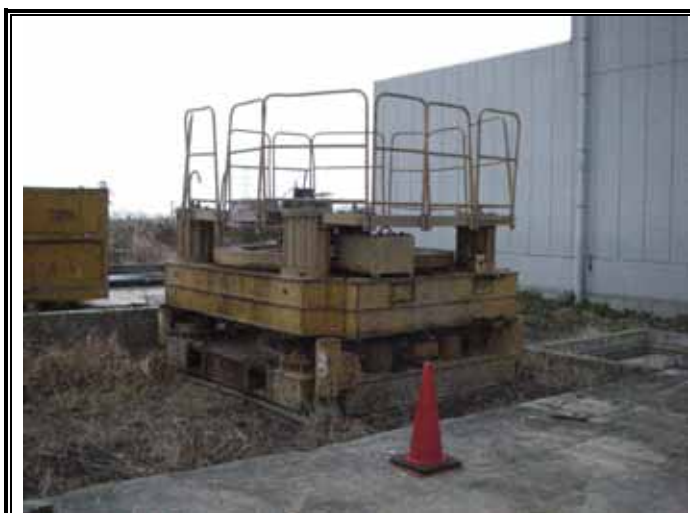
全周回転式油圧ジャッキ設置
