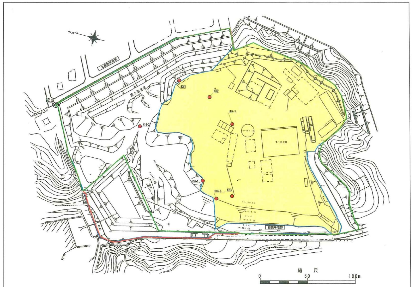
当該処分場にある廃棄物調査として、平成 12 年度より処分場内、北尾側平坦部等でガス調査を行い、硫化水素やベンゼンをはじめとする VOC ガスが検出されていることを確認した。そのため、高濃度ガスが検出された箇所 (A-1, A-2 区域) でオールケーシング掘削調査を行い、廃棄物の性状と層厚を確認した。
