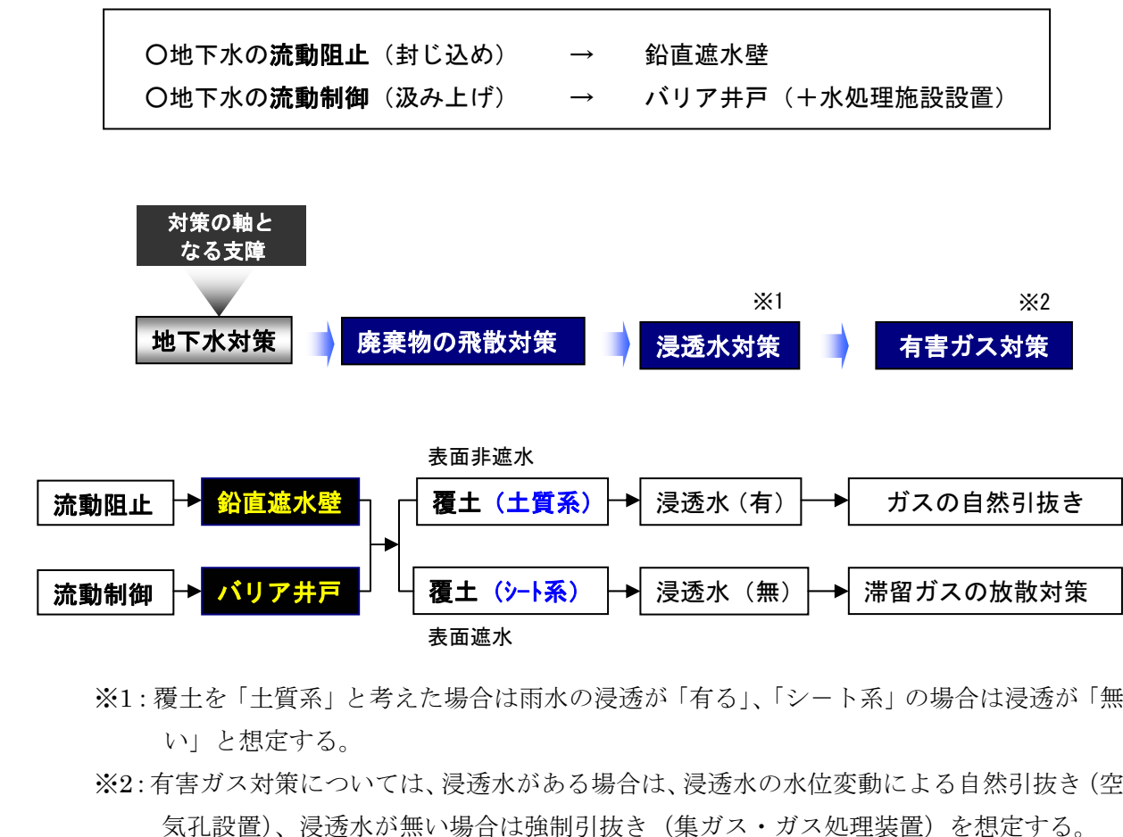
図 2.2-1 具体的な対策工法の併用方法の段階的な検討の考え方
