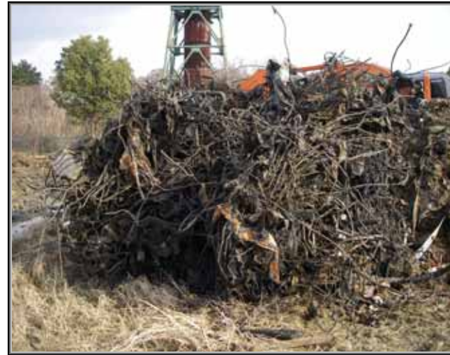
写真 4.7 -1 掘出された鉄筋塊
