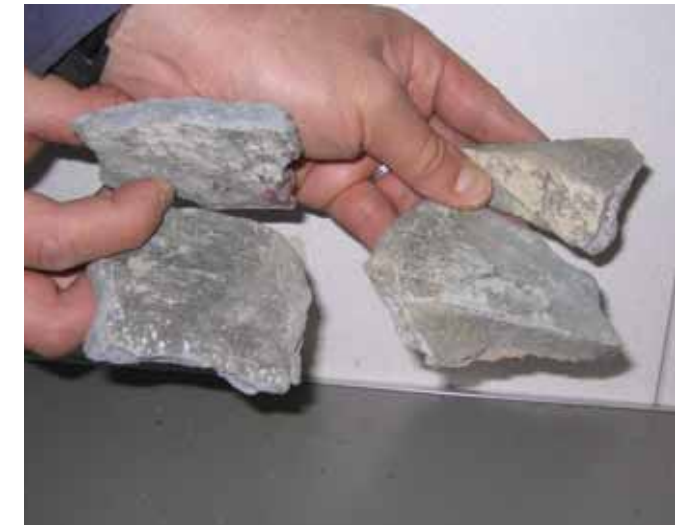
写真 3.6 切削クズ中の建材
