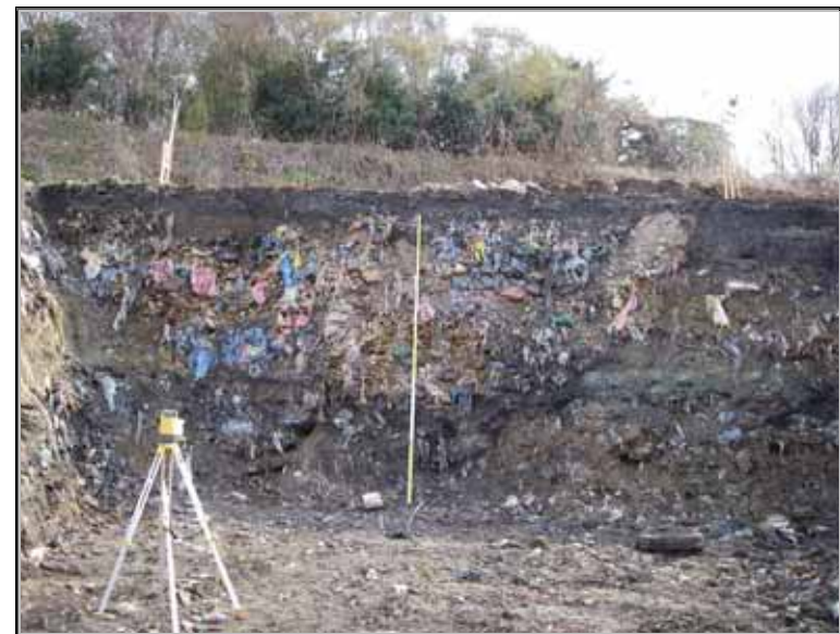
写真3.4 医療系廃棄物の埋め立て状況(その2)
