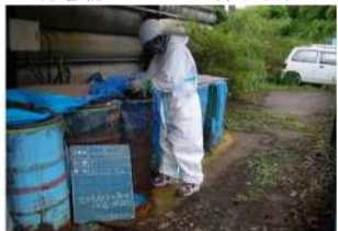
⑤焼却灰を集積したドラム缶 焼却灰採取状況
