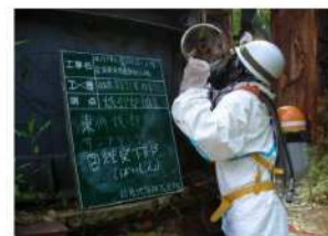
②煙突下部（点検口） ばいじん採取状況
