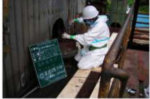
③集塵機上部 付着物・ばいじん採取状況
