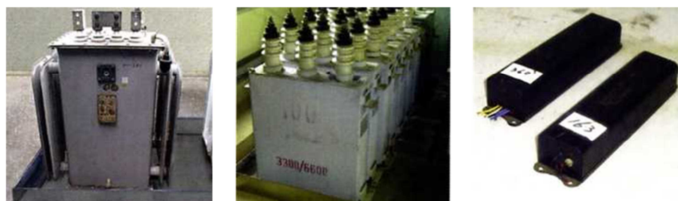
高圧トランス 高圧コンデンサ 安定器
