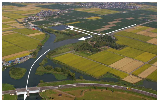
河川直接浄化事業の例(植生浄化)
