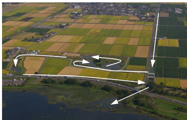
浄化池や水生植物等による農業排水浄化(草津市)
