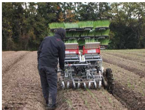
新規導入された全自動定植機による定植
