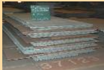
桁の材料となる鋼の板を
