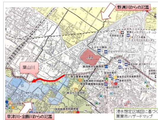
図-1 浸水想定区域図に基づく栗東市のハザードマップ（平成19年版、平成26年に地先の安全度マップも反映させたハザードマップに改訂されている）
