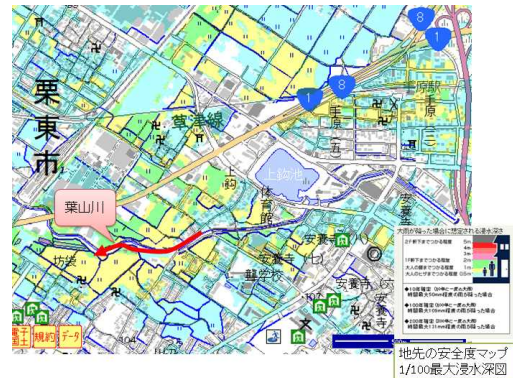
図-2 地先の安全度マップ1/100最大浸水深図
