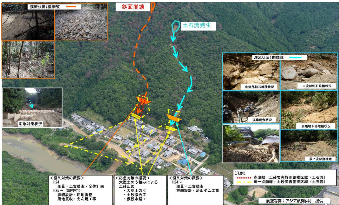
図-14 応急対策および恒久対策の概要
