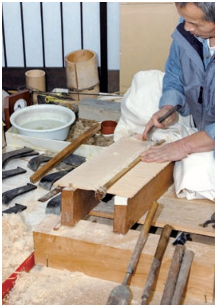
▽一枚の板のようにした1,300枚の扇骨を磨く作業が繰り返される
