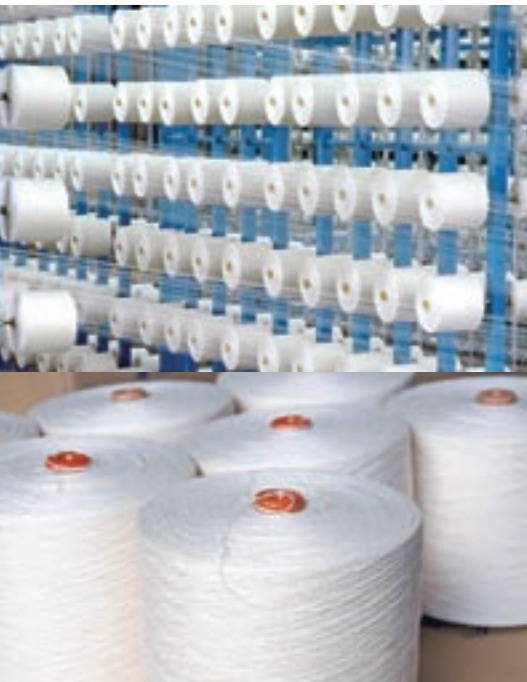
▽経糸が加工されるサイジング工場内荒巻整経機
