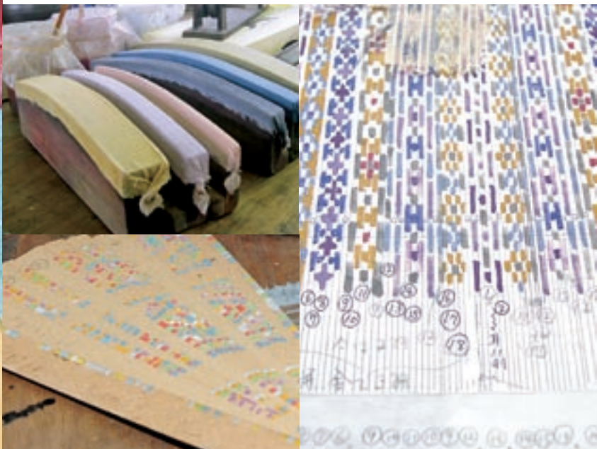
△(上)櫛押捺染に使う弓形の木片 (下)細長い段ボールを重ね合わせ、東にした手作りの羽定規
